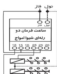
توجه ۱: از وصل کردن مستقیم بارهای خازنی یا سوئیچینگ یا درایورهای LED به دستگاه به دلیل جریان بیش از حد راه اندازی در این نوع معرف کننده ها، خودداری گردد. در این موارد الزاماً از رله خارجی یا کنتاکتور ترانزیستور استفاده شود.
