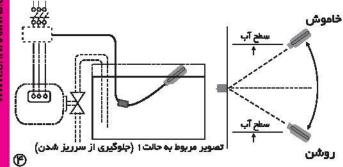
شيوا امواج با سنسور مخصوص و منحصر به فرد استفاده نماييد. فلوترهاي الكترونيكي شيوا امواج داراي پيچ تنظيم حساسيت براي مایعات مختلف با مقاومت های متفاوت می باشد، همچنین در این فلوتر
